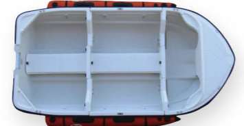
パワー部分、センターシート、スターンシートの内部にはウレタンびっしり!
