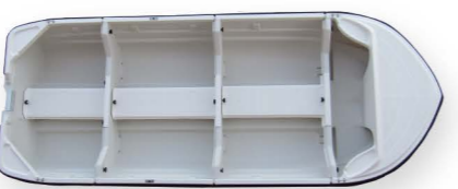
パワー部分、パウシート、センターシート、スターンシートの内部にはウレタンびっしり!
