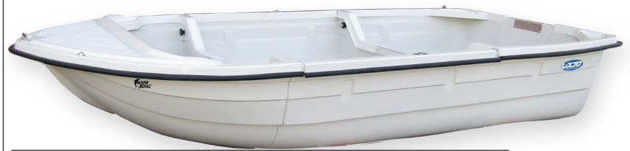
パワー部分、センターシート、スターンシートの内部にはウレタンびっしり!
